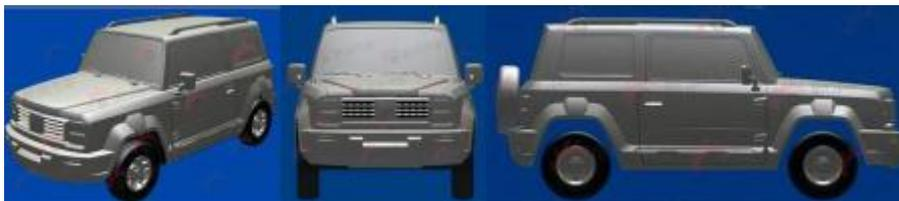
这款车的外形尺寸是长 3815mm 宽 1762mm 高 1670mm，轴距尺寸 2370mm。整体都要比铃木吉姆尼车型放大了一些，同样采用 2+2 的四座式设计，理论上车内空间应该更有优势一些。而且这款 GX5 的最小离地间隙达到了 180mm，加上短轴距和非常短小的前后舷，使得车型的越野能力大幅提升。
